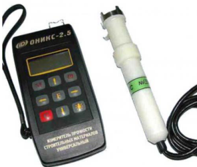
Fig.1. Measuring the strength «Onyx-2.5»
