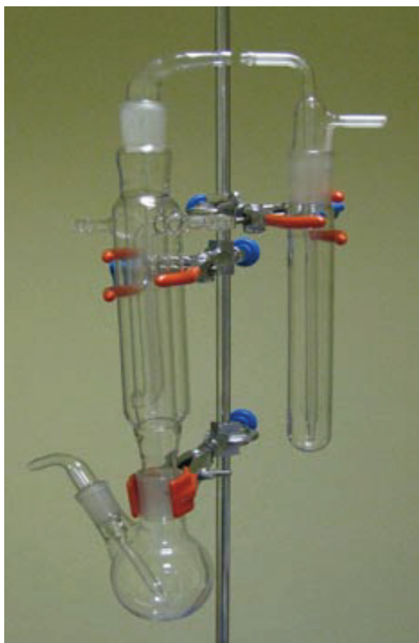
Рис. 2. Установка для определения H_2S по методике IP 399/94.
