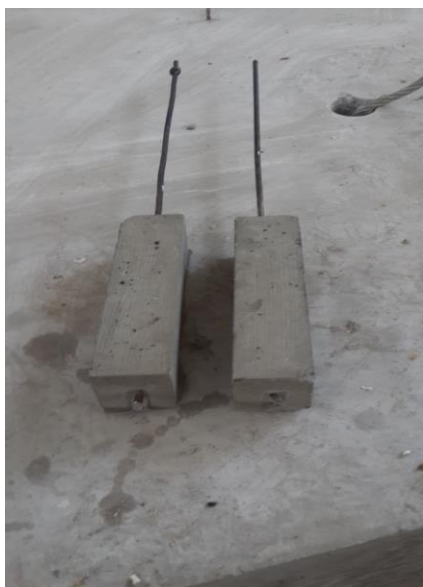
Рис. 3. Дослідні зразки з гладкою арматурою до випробування
