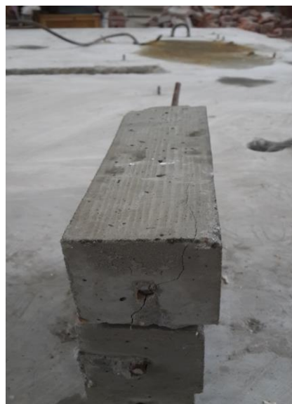
Рис. 4. Дослідний зразок з гладкою арматурою після випробування
