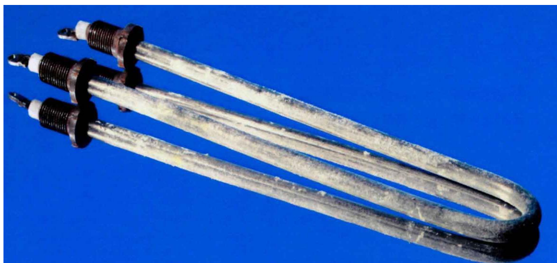
Рис. 9. Результаты эксперимента. ТЭН из воды, обработанной аппаратом CALMAT, одним из разновидностей приборов фирмы
