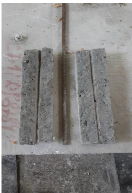
Рис. 5. Дослідний зразок з ребристою арматурою після випробування
