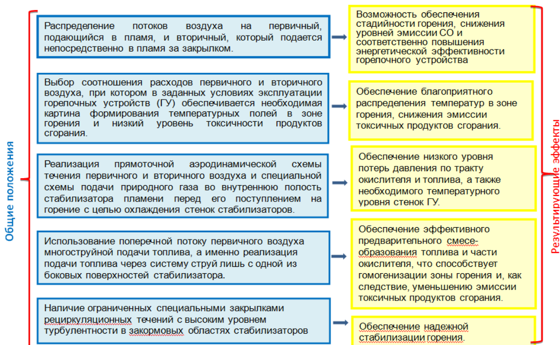
Рис. 7. Общие положения по организации рабочих процессов горелок с асимметричной подачей топлива
