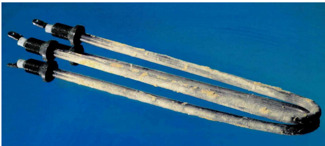
Рис. 8. Результаты эксперимента. ТЭН из необработанной воды
