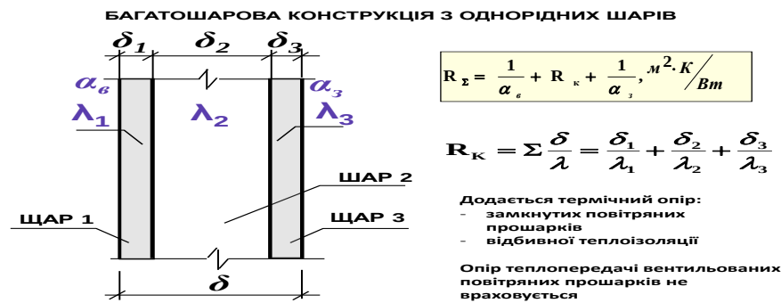
Рис. 2. Розрахунок опору теплопередачі багатошарової огорожувальної конструкції
