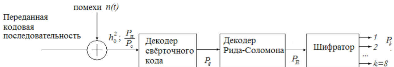
Рисунок 1 – Структурная схема взаимодействия декодирующих устройств
